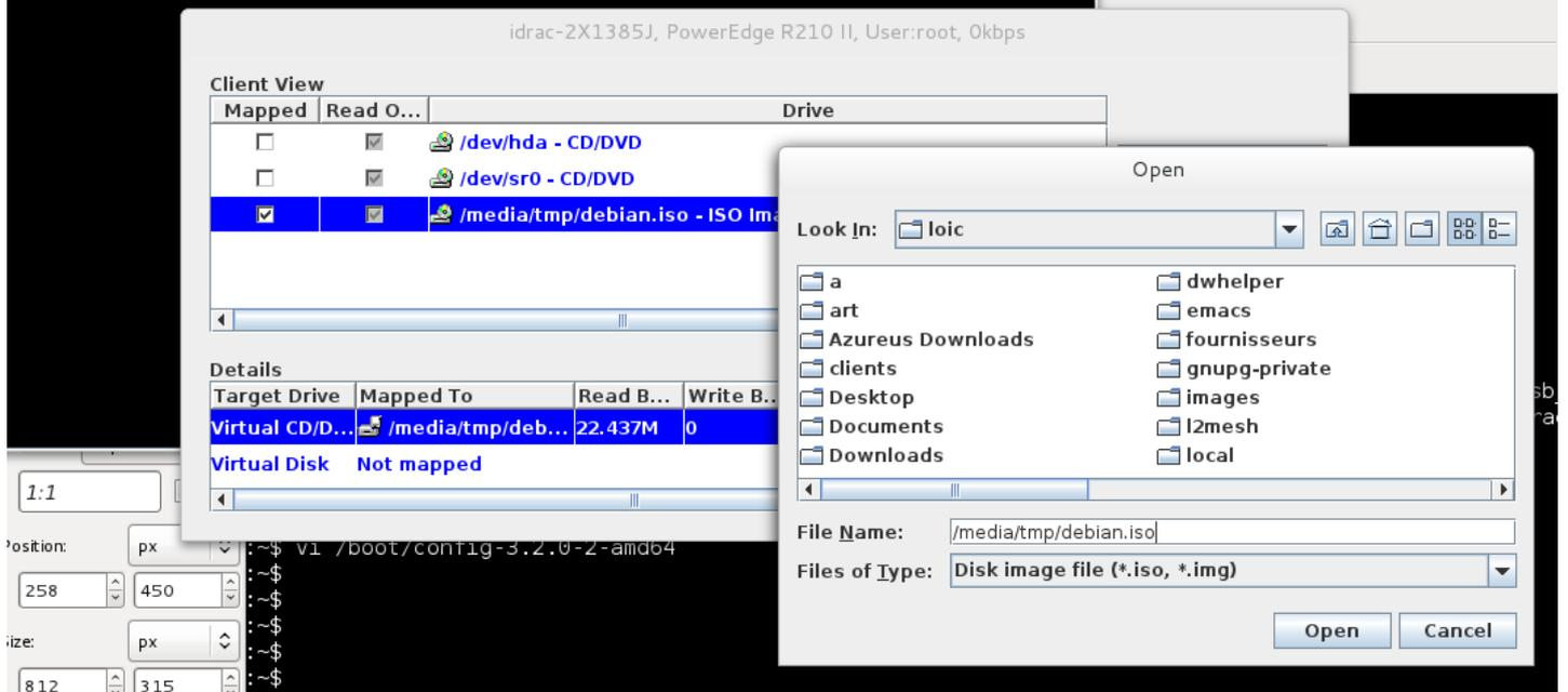
Rebooter avec "Macros" => "Control-Alt-Del", taper sur F11 pour avoir le menu de boot et sélectionner le device virtuel iDrac.
